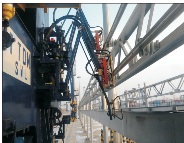
受电滑板 and 滑线紧密接触
